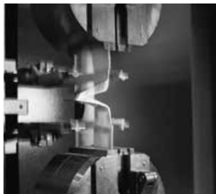
Billede 2: Trækprøve i RHEINZINK-kvalitetskontrollen
